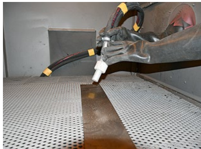
Strahlen mit Korund im Werk
